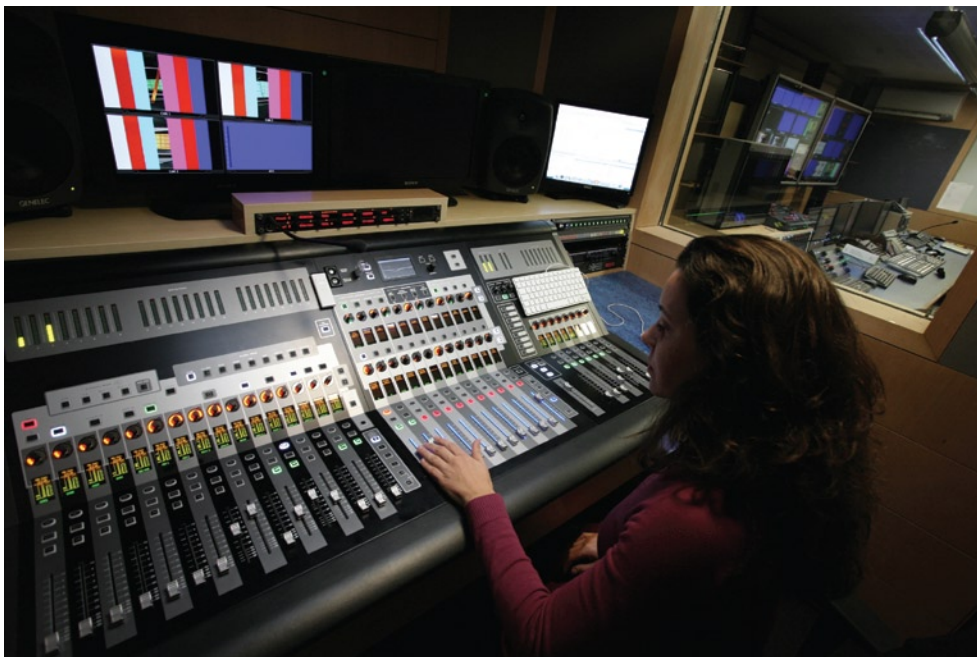
A zona de controlo de áudio, anexo à régie de produção principal, é dominada por uma mesa digital Si2 da Soundcraft. Esta cabine permitiu-nos admirar o excelente trabalho de desenho e tratamento acústico efectuado por Marcelo Tavares e pela sua empresa Audiodesigner que se encarregou destes aspectos em todas as salas das instalações do canal
